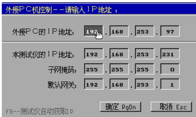
确认好后选择确定测试仪即进入联机状态。打开计算机网络连接选择属性——IPV4 协议
