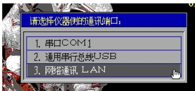
三、外接 PC 指的是计算机的 IP 地址，首先确认外接 PC 和本测试仪 IP 地址与默认网关三个的 IP 网段是否都一致，比如下图 192.168.253.97
