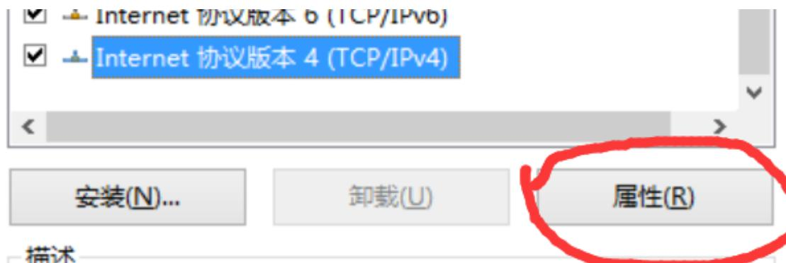
如下图设 IP 地址与测试仪的 外接PC的 IP 地址: 192 . 168 . 253 . 97
