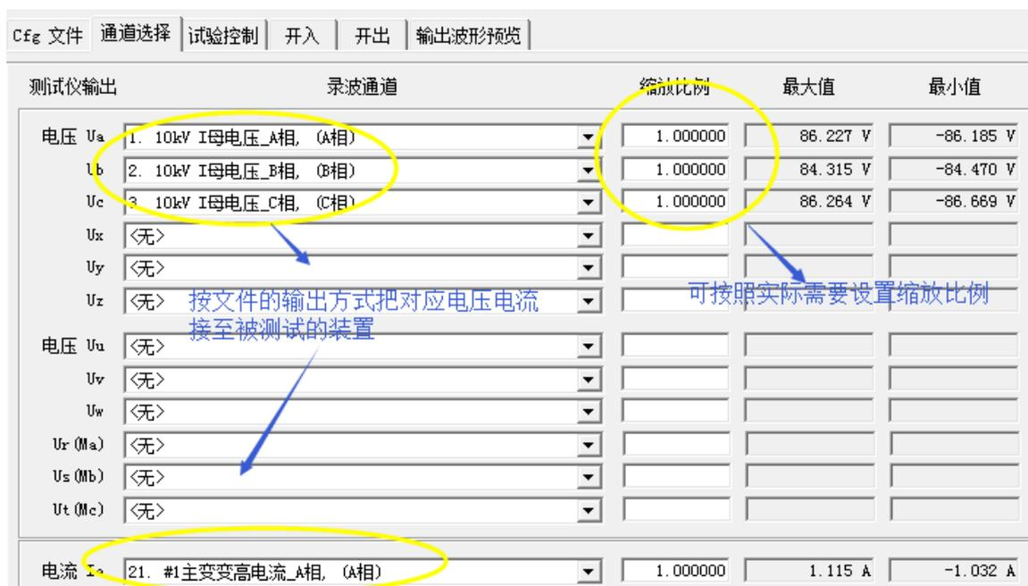
第五步：试验控制：选择波形回放的起点和终点；和波形回放的触发方式；可按键或时间。
