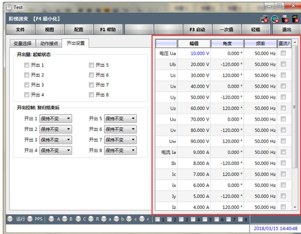
测试窗口的右视图为试验过程的辅助显示区，以数字形式显示当前的电压电流输出，包括幅值、相位、频率、直流等，可通过滚动条上下拉伸拖动显示区域获得想要显示内容。
