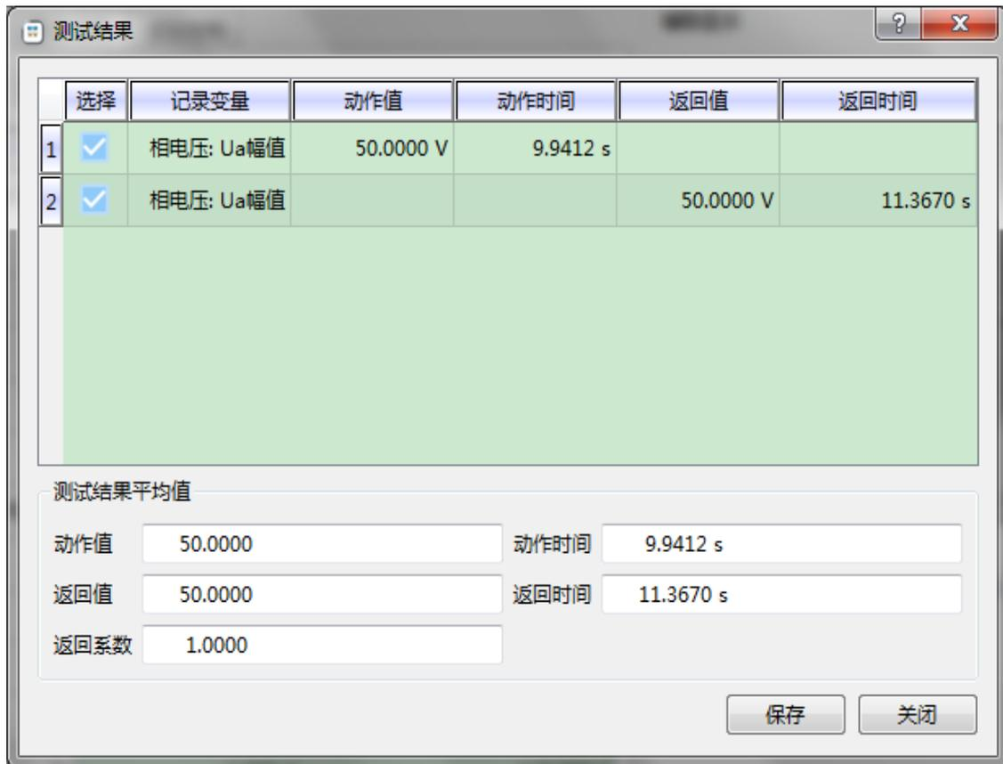
试验过程中，测试仪可根据接点的翻转，记录多次的动作和返回值结果。
