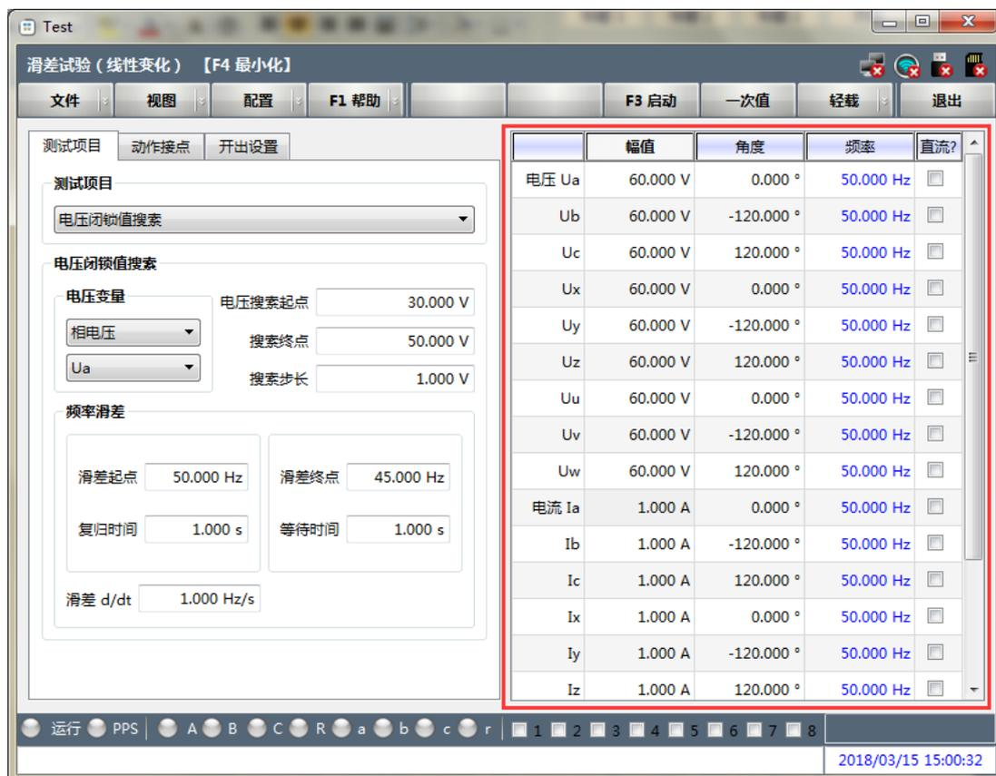
测试窗口的右视图为试验过程的辅助显示区，以数字形式显示当前的电压电流输出，包括幅值、相位、频率、直流等，在试验前可设置各个通道输出的幅值角度和频率。
