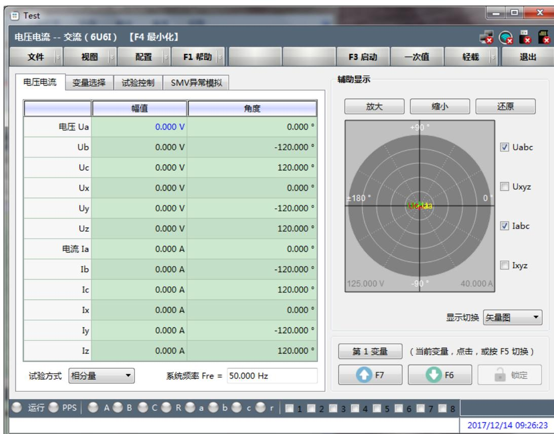
实时设置并显示当前各通道电压电流的幅值、角度、系统频率。
