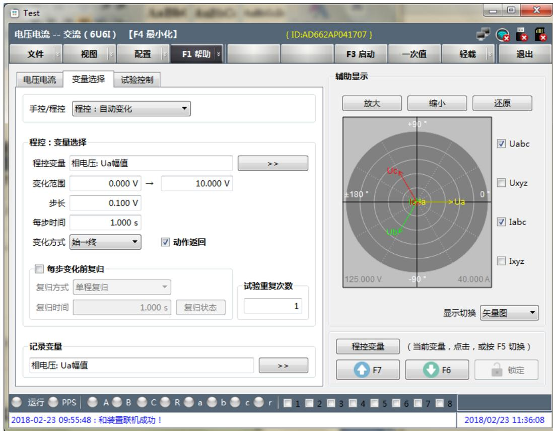
程控可以根据相关的设置，代替用户实现“当前变量”的自动变化控制。
