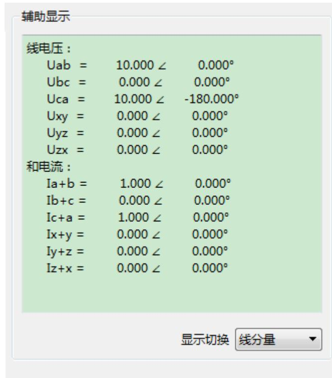
实时显示当前电压、电流输出所对应的线电压、和电流。
