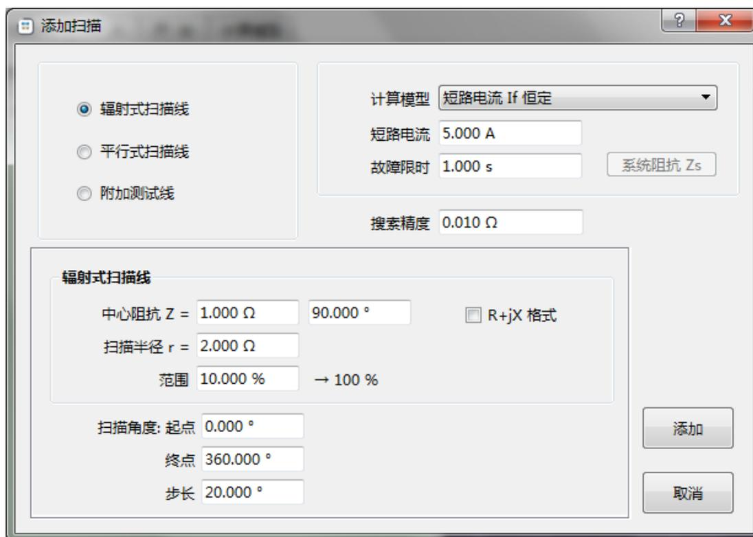
根据阻抗整定特性的不同，程序提供了两种不同的扫描方式：辐射式，平行式。
