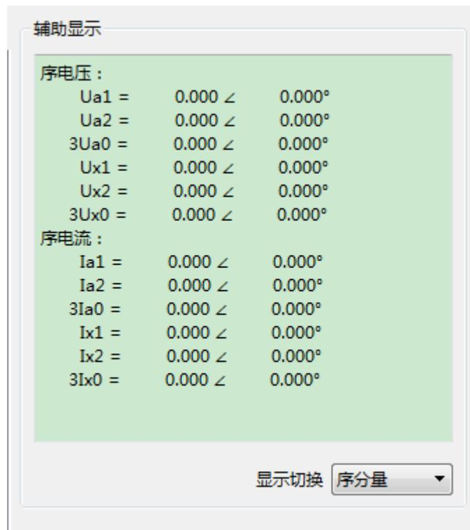
实时显示当前电压、电流输出所对应的正序、负序和零序的电压、电流。
