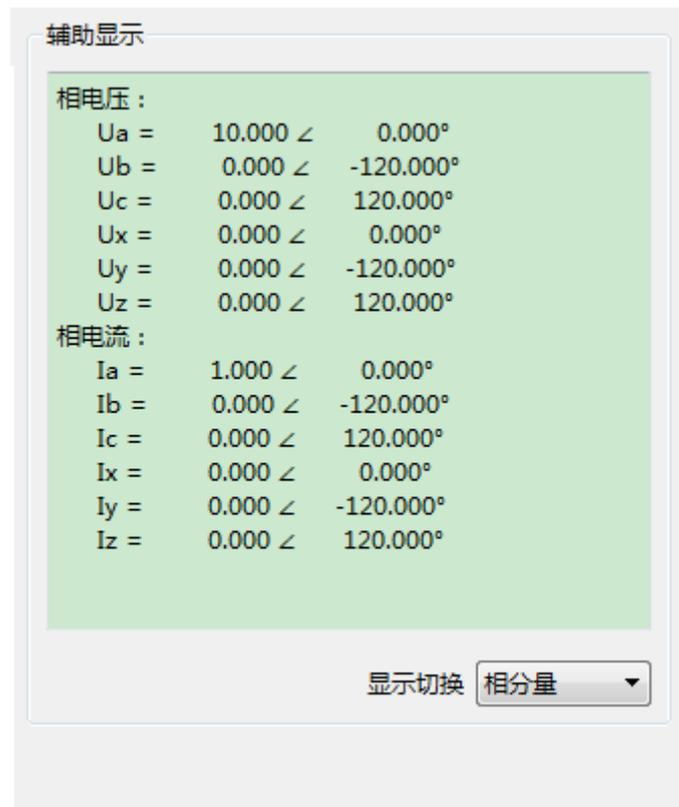
实时显示当前电压、电流输出所对应的相电压、相电流。
