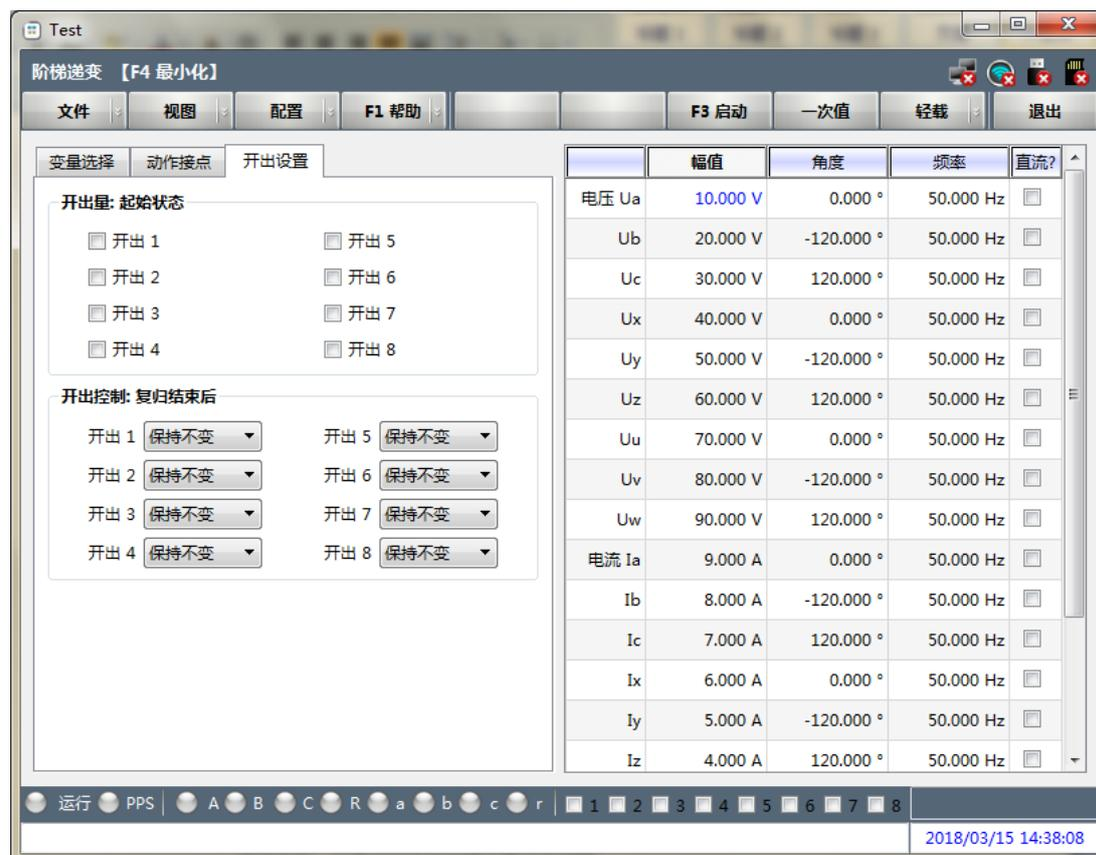
设置在复归状态及复归状态结束后的开出量状态。
