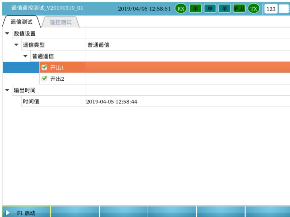
◇ **遥信风暴：**遥信风暴测试用于测试被测装置某个开入通道对短时间内的大量遥信变位是否有能力处理。测试仪在短时间内，模拟现场的遥信风暴事件，测试被测装置是否有漏收遥信变位信号。设置如下图：
