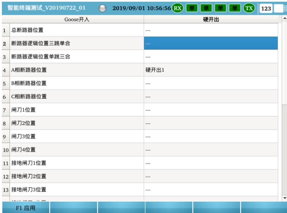
选择 F6 测试接点映射，映射对应的硬接点，映射完成之后按 F1 应用：
