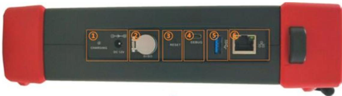
**CHARGING/DC12V:** 充电指示灯/交流电源接口，建议使用厂家配送的适配器进行充电。
