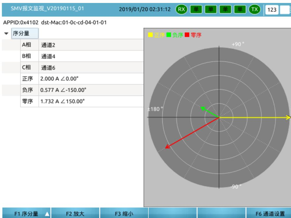
**功率**：在 SMV 报文监控界面按 F1 功能键，选择“功率”，可选择显示当前 SMV 控制块的电压电流，如图所示，进行有功/无功/视在功率的计算。
