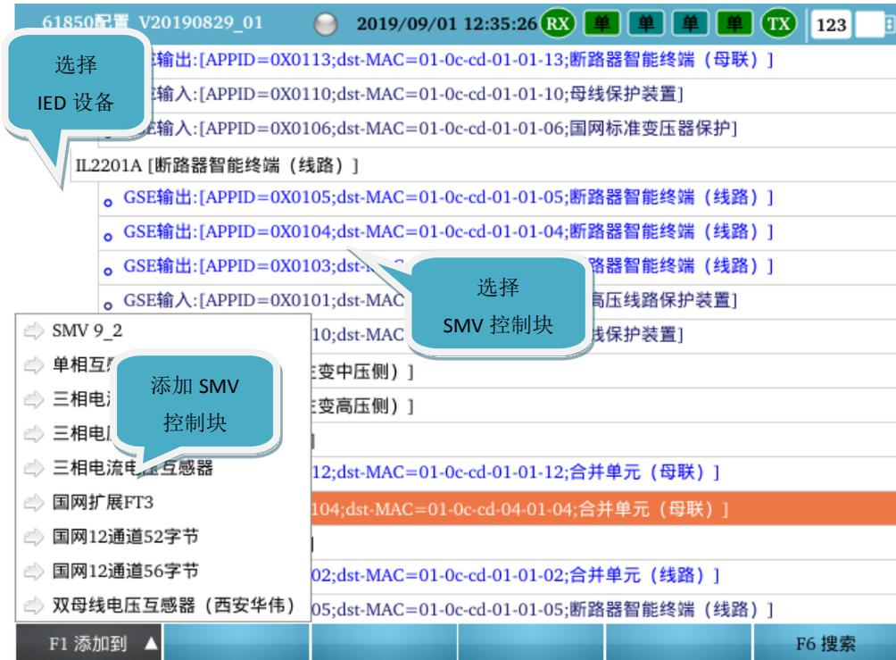
③ 返回到“IEC-61850配置”界面，在“SMV配置”页面，即可看到通过导入SCD文件添加的SMV控制块。然后根据实际的光纤接线，设置SMV的输出光口；根据保护的实际情况，将测试仪的数字量输出通道与保护的采样通道进行一一映射，详见下图：
