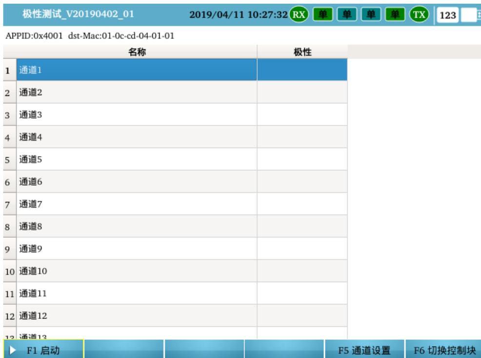
4) 按 F1 启动极性校核，界面会直接显示极性校核的结果。欲重做试验，直接按停止然后再开始即可。(如下图)
