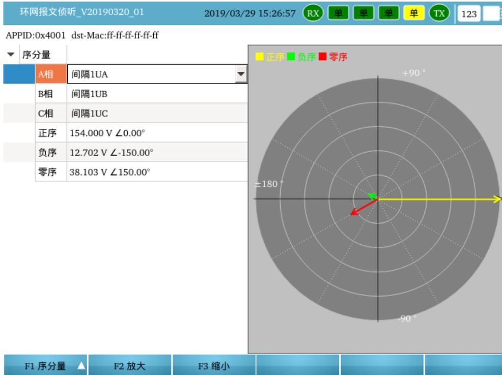
**功率：**按 F1 功能键，选择“功率”，可选择显示当前 SMV 控制块的电压电流, 如图所示，进行有功/无功/视在功率的计算。
