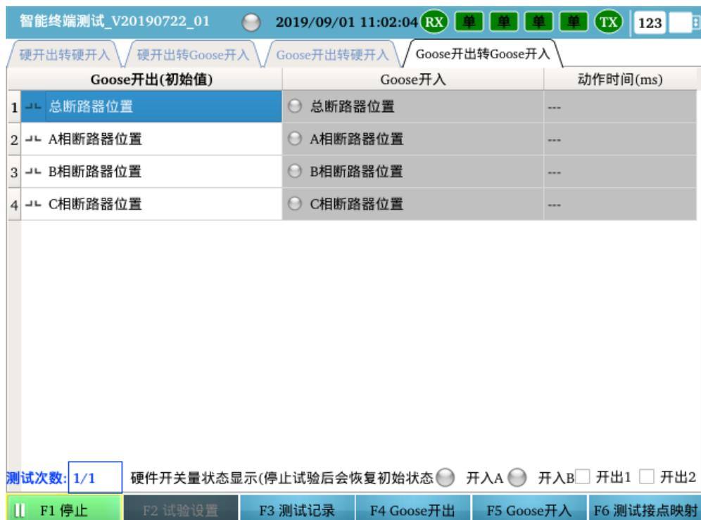
操作步骤如下：选择 F4Goose 开出，添加对应的 Goose 控制块，对控制块内的通道进行接点映射，启动试验，记录结果。
