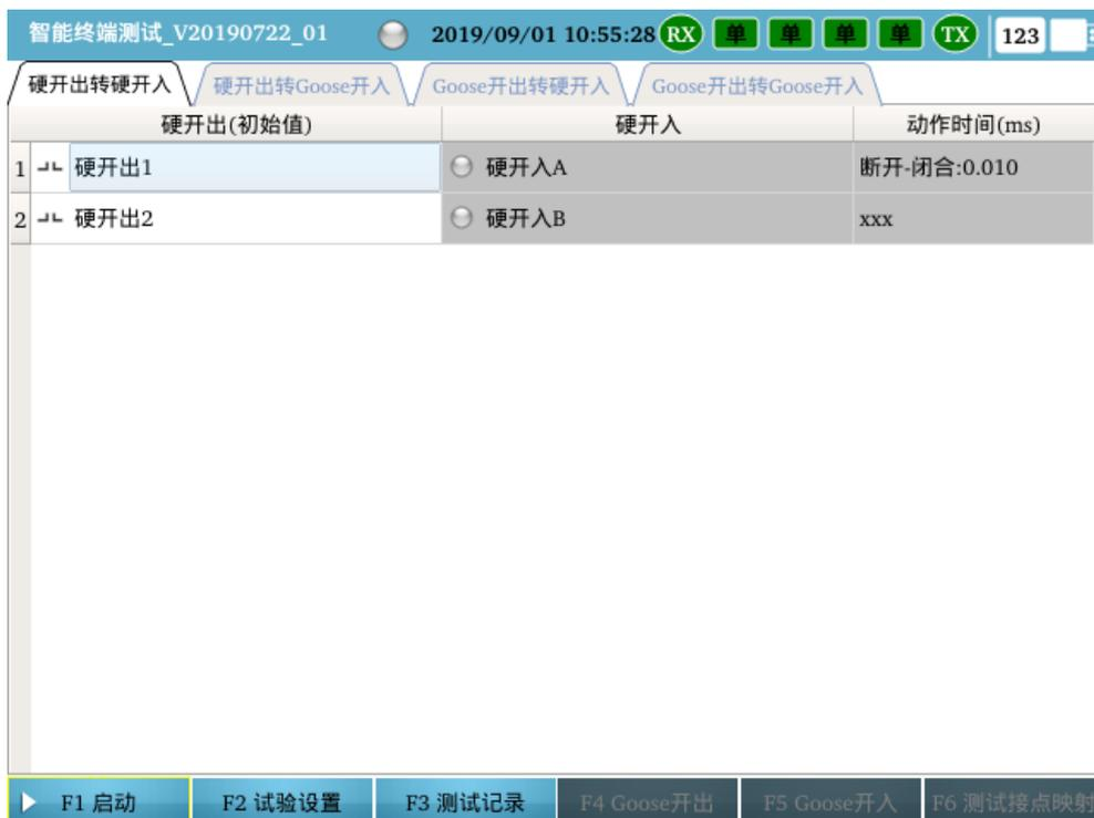
**硬开出转 Goose 开入：**测试硬开出接点转 Goose 开入的延时。
