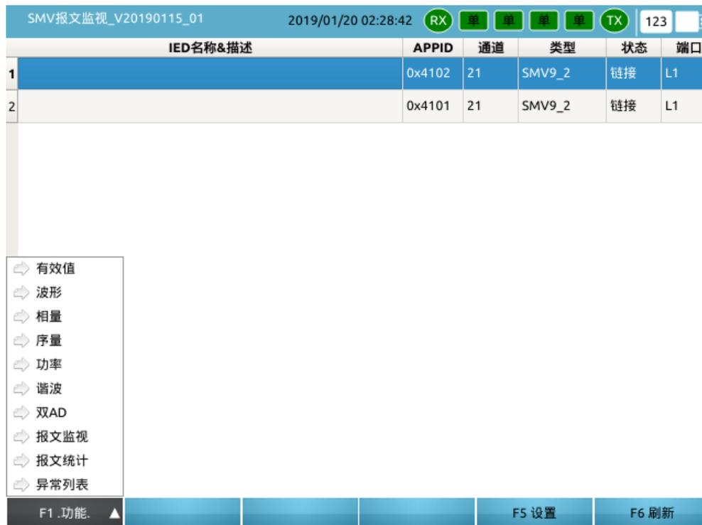
按 F1 进入功能显示切换的区域，有效值、波形、相量、序量、功率、谐波、双 AD、报文监视、报文统计、异常列表可通过上下方向键切换。
