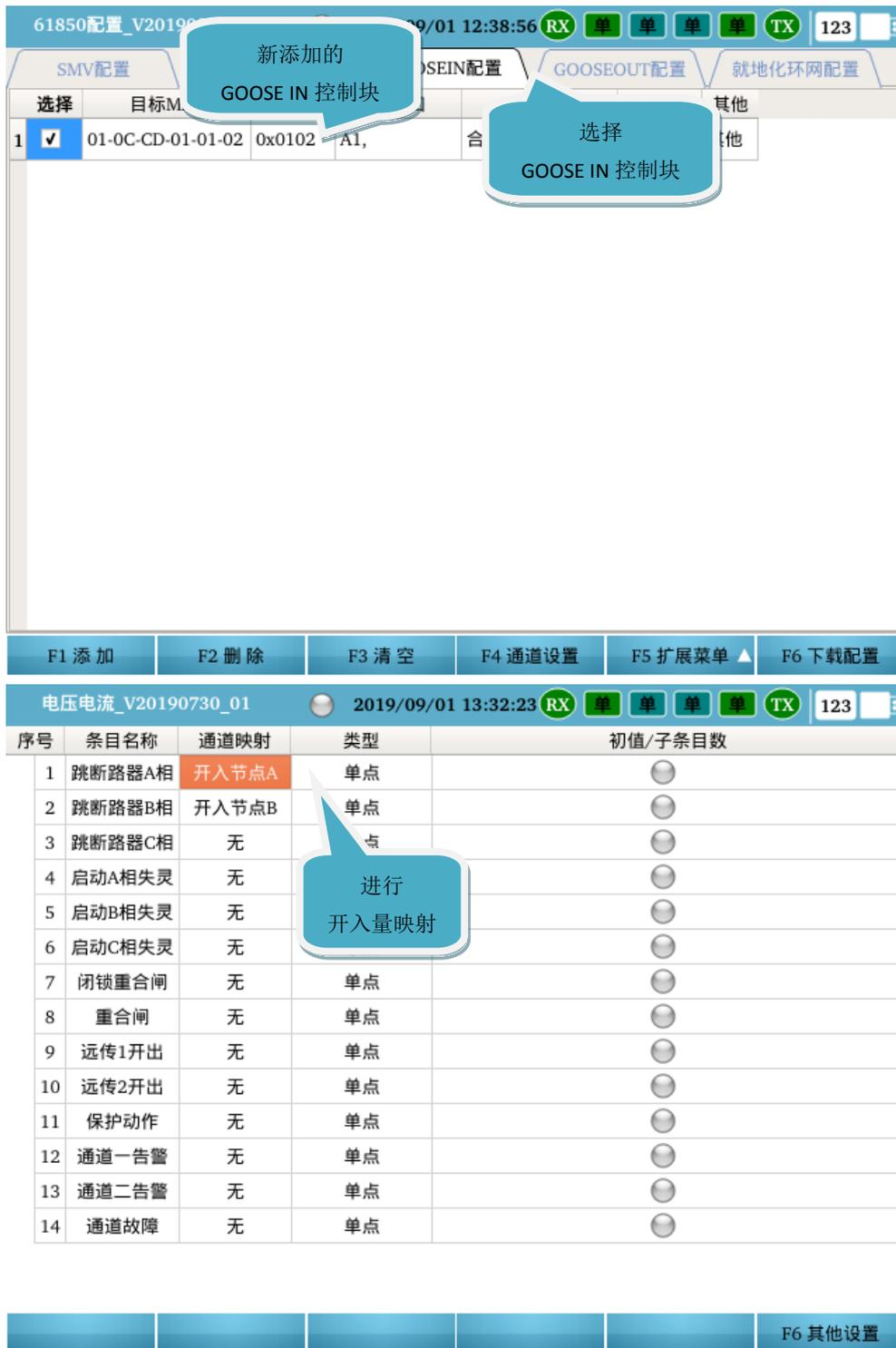
SMV和GOOSE配置完成后，点击工具栏的“
