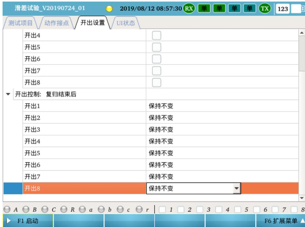
设置在复归状态及复归状态结束后的开出量状态。
