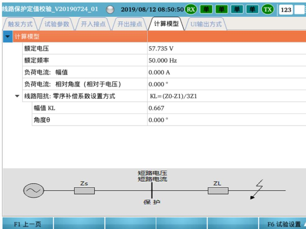
注：本测试菜单，程序把短路计算模型固定为“短路电流 If 恒定”。
